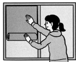
外からの飛散物で窓ガラスが割れる危険があるため、窓の内側から飛散防止フィルムをはる。
