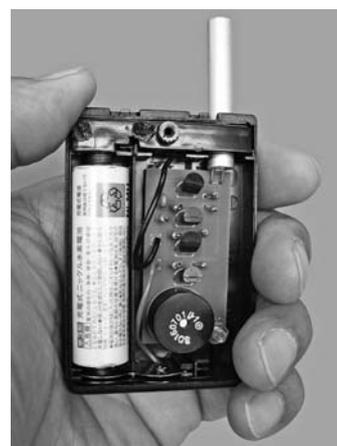
色の変化、光の反射・屈折の実験など、盲学校での理科実験の様々な場面使われています。なくてはならない道具ですが、市販品は一台数万円しますが、JASERB代表をされている元筑波大学の鳥山先生を中心に、盲学校での理科実験のやり方のノウハウを、東南アジアなど発展途上国に普及させる活動をされているのですが、この価格が大きな障壁でした。そんな事もあり、「千円で感光器を作れないか」と鳥山先生から問われて作ったのが、右の写真の感光器です。実際にいろいろな所で使われています。高専や工業高校でこの感光器を組み立てて近隣の盲学校に渡すという使われ方もされています。自分の技術が、実際の役に立つという、とても楽しい経験でした。
